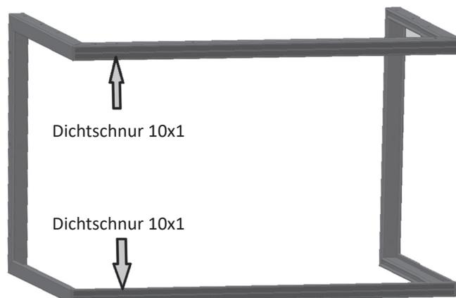
2.2 Kleben Sie die **10x1 Dichtschnur** auf den unteren und oberen Streifen der Frontscheibe.
