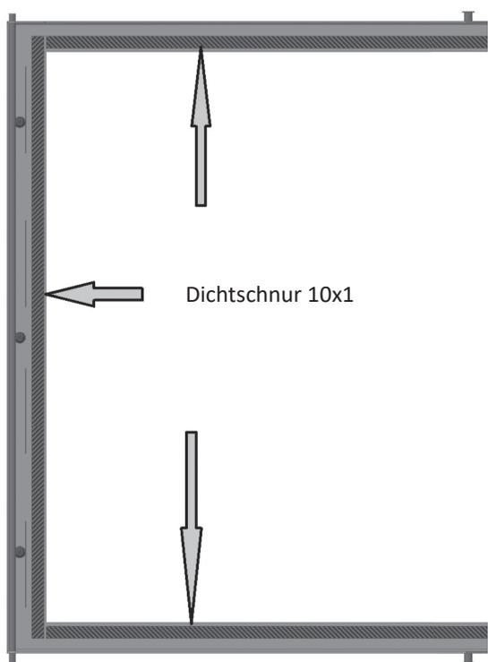
2.4 Kleben Sie eine **Dichtschnur 10x3** zwischen die Schrauben am Seitentürrahmen
