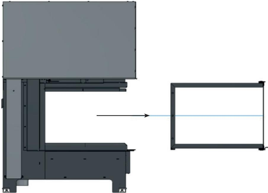
1.5 Entfernen Sie die alten Dichtungen und reinigen Sie den Rahmen gründlich von Silikonresten.
