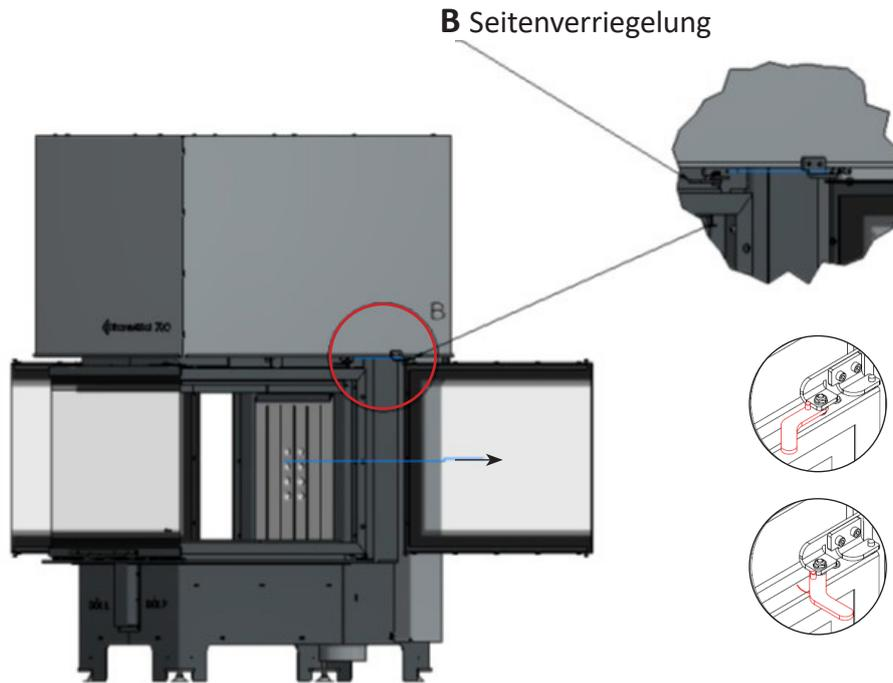
1.3 Lösen Sie die Schrauben der Türbefestigungen an den Kamintüren auf beiden Seiten.
