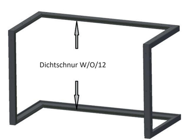
Sind die neuen Dichtungsschnüre eingeklebt, können Sie die Tür wieder einbauen, ausrichten und festschrauben. Zum Schluss sichern Sie wieder die Seitentüren mit den Verriegelungen **B (s. 1.2)**.
